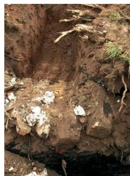
**Baggerschurf mit Bauschutt und Porzellanablagerungen im Bereich des verfüllten Altarms**
