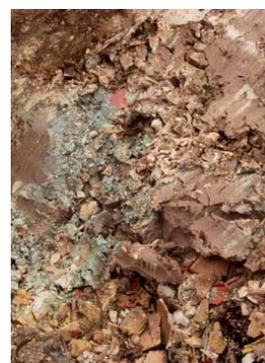
**Baggerschurf mit Teer- und Porzellanablagerungen im Bereich der Auffüllfläche**
