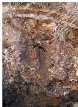
**Baggerschurf mit Farbpigmenten und Porzellanablagerungen im Bereich der Auffüllfläche**
