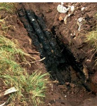
**Baggerschurf mit Teerrückständen und Mauerwerk der Teergrube**
