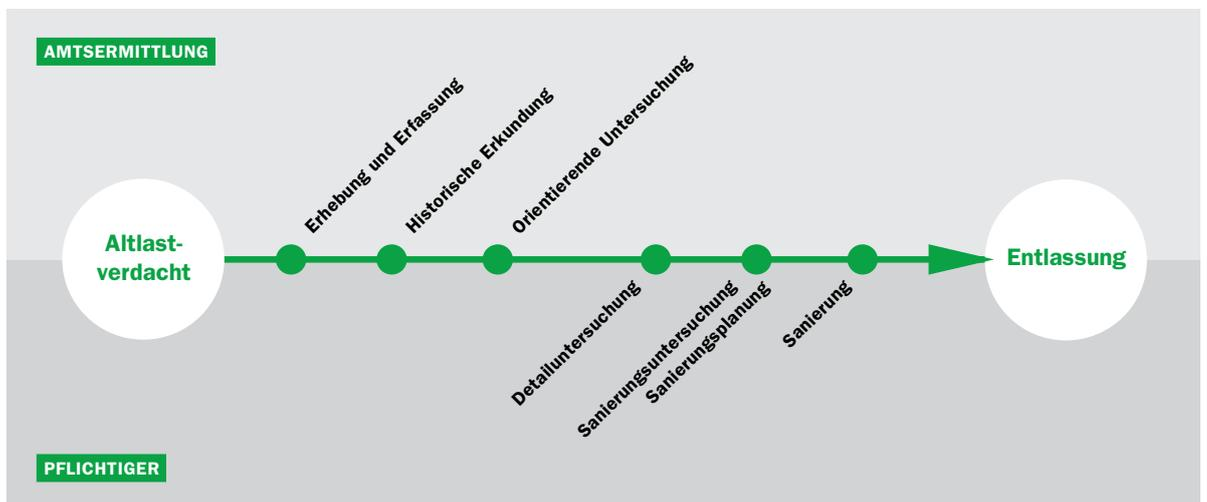
Ablaufschema Altlastenbearbeitung gemäß BayBodSchVwV
