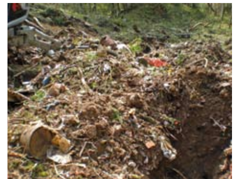
Materialzusammensetzung des mit Siedlungsabfällen durchsetzten Aushubmaterials (Abb. 2)
