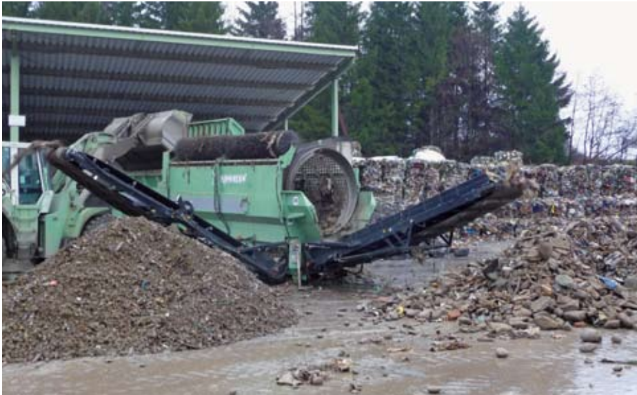
2. Behandlungsschritt mittels Trommelsieb mit 80 mm Trennschnitt (Abb. 5)
