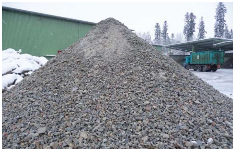
Recyclingfraktion nach der Abtrennung von nicht-mineralischen Bestandteilen, wie Folien, Plastik, Holz und Schrott (Abb. 7)
