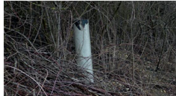
Angefahrene Messstelle, in ca. 0,5 m Tiefe ist das Vollrohr abgeschert – direkter Zufluss von Oberflächenwasser in das Grundwasser ist gegeben
