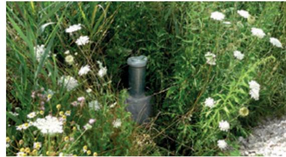
Beschädigte Messstelle, fehlende Abdeckung
