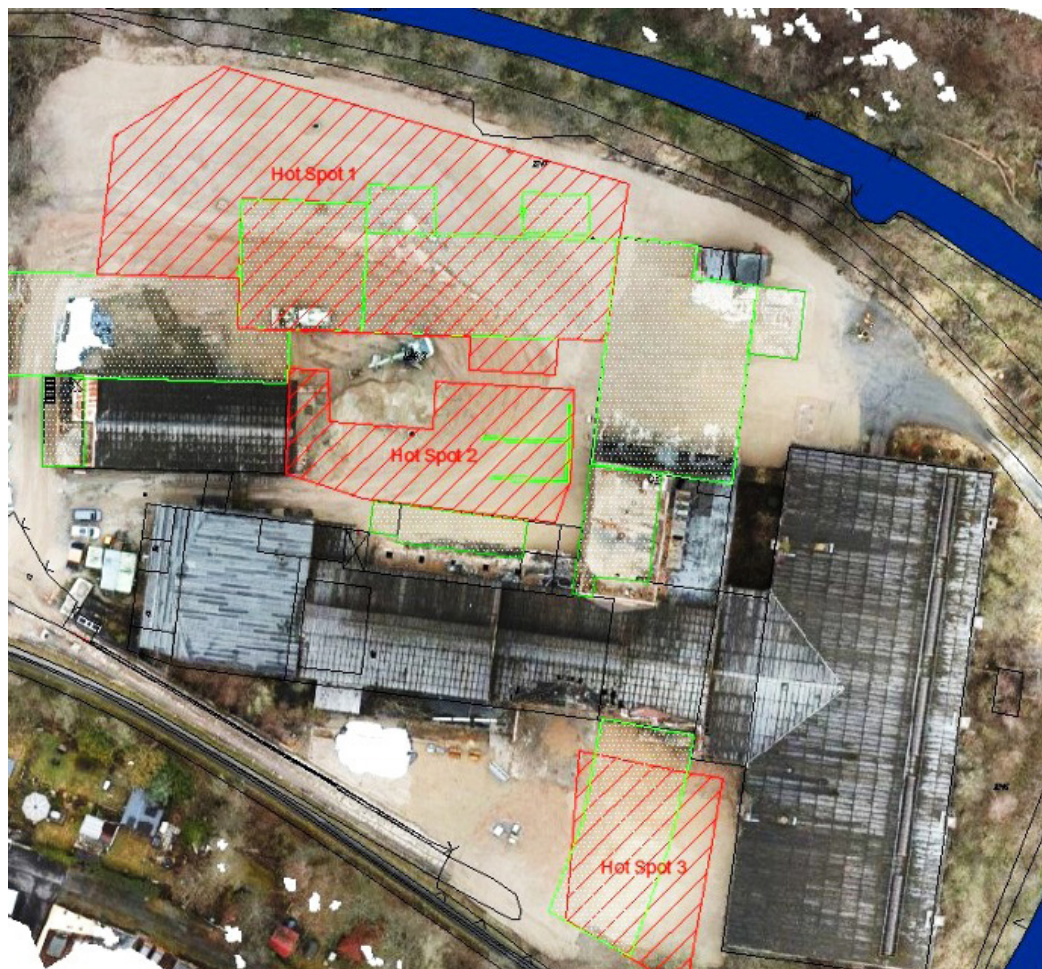
Überlagerung der abgebrochenen Gebäude (grün) nach Sanierung der Hotspots (rot) mit aktuellem Luftbild (3)
