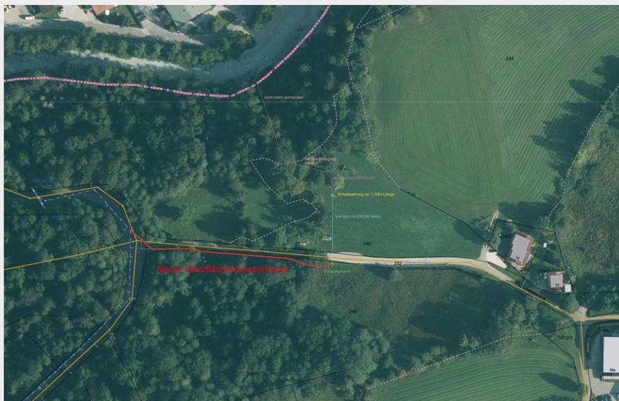
Vorplanung der Oberflächenentwässerung auf Orthophoto mit Darstellung der beschädigten Bestandsleitung am Deponie-Ostrand und Skizze des neuen Oberflächenwasserkanals (3)
