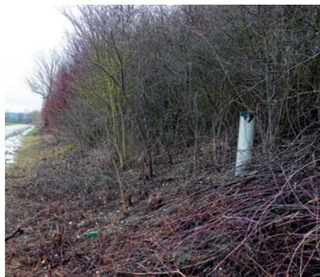
3) Beschädigte Messstelle, fehlende Abdeckung.
