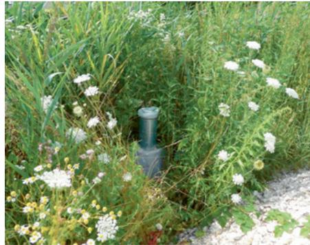
1) Überwucherte Messstelle neben Haufwerk – die Messstelle ist gerade einmal 3 Jahre alt!
