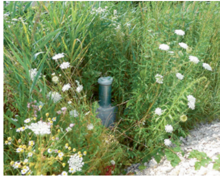
1) Überwucherte Messstelle neben Haufwerk – die Messstelle ist gerade einmal 3 Jahre alt!
