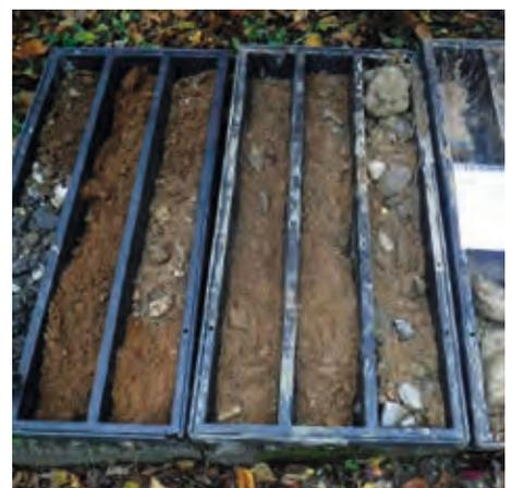
Abb. 7: Quartäres Schichtprofil der Bohrung P40
