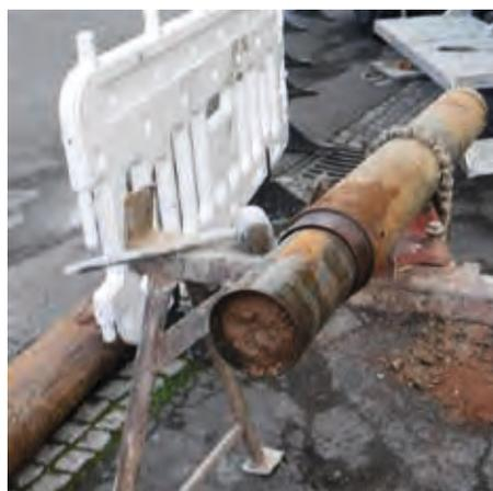
Abb. 6: Gewinnung von Liner-Bodenproben an GWM-Bohrung P39
