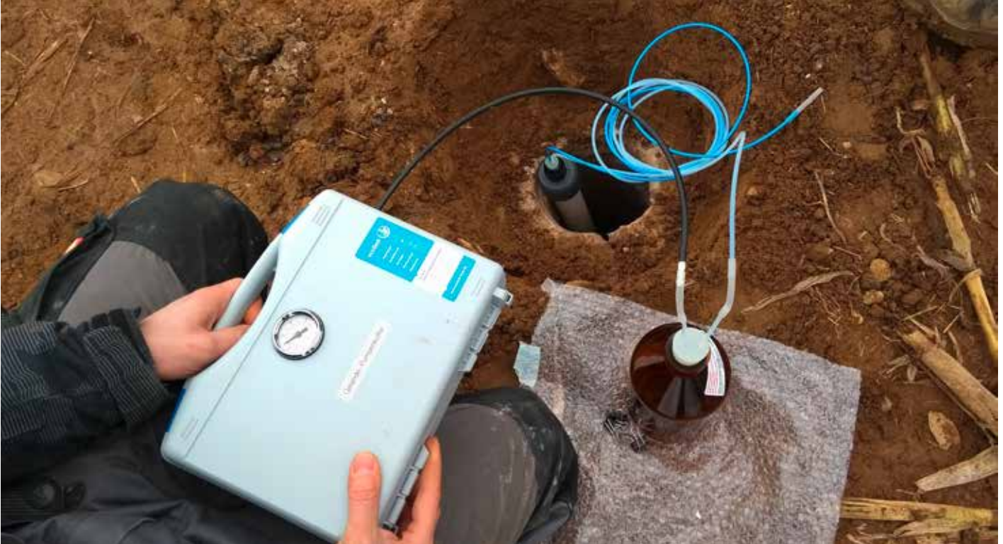
Anlegen von Unterdruck über die Glasflasche zur Entleerung des Sammelgefäßes (noch vor Abschluss des Messstellenausbaus)
