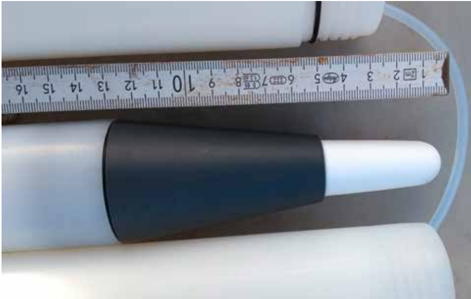
Membran einer Glassaugkerze (Bildmitte) vor dem Einbau
