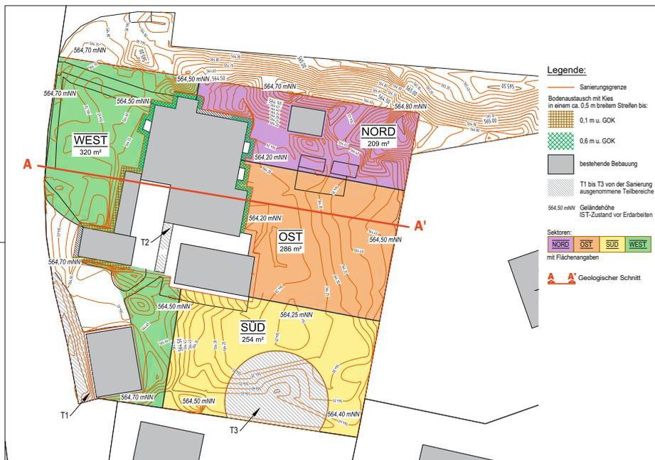
Lageplan mit Höhenangaben (IST-Zustand) und Schnittverlauf
